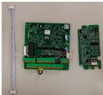
Рисунок 2 – Места подключения платы STO к плате управления
