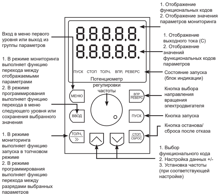
Рисунок 6 – Описание панели управления LCI-KP
