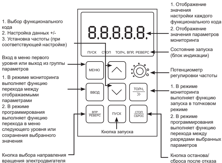
Рисунок 5 – Описание панели управления LCI-KP-S
