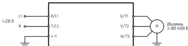
Рисунок 2в – Подключение силовых клемм
