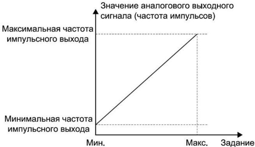
Рисунок 10.10-2. – Амплитудная характеристика импульсного выхода
