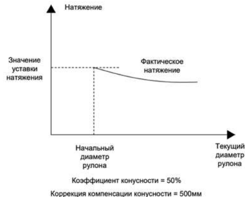
Рисунок 10.20-2. Изменение коррекции компенсации конусности
