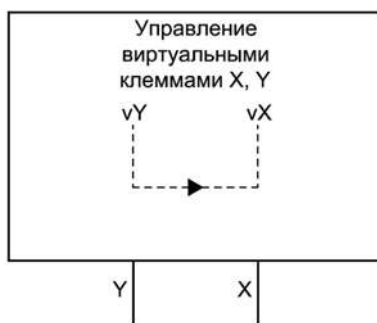
Виртуальное соединение виртуальных vY и vX , позволяющее использовать Y и X для других физических подключений
