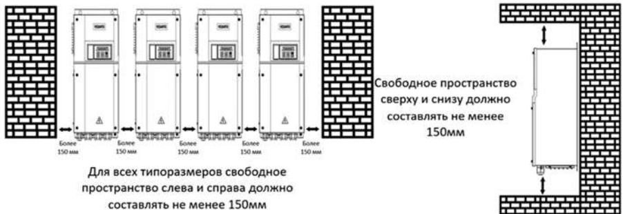
Рисунок 3.7-2. – Рекомендуемые монтажные расстояния для преобразователей частоты VF-101 DBC
