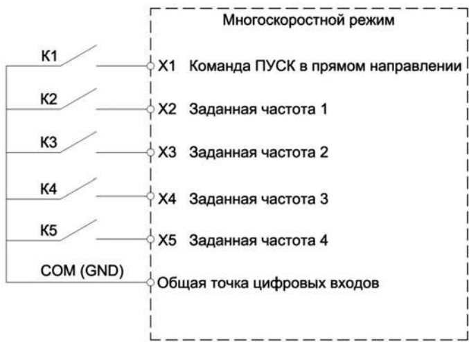
Рисунок 10.18-1 – Схема подключения цифровых входов для реализации многоскоростного режима
