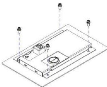
**Шаг 3:** Совместите пазы крепления кронштейна с выемками на задней стороне пульта, нажмите на кронштейн и сдвиньте его вниз в положение фиксации.
