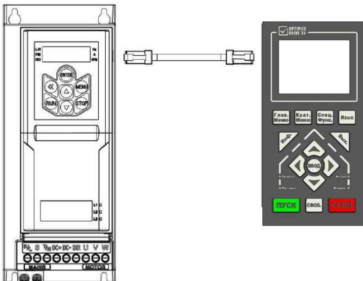
Для подключения пульта к преобразователю частоты используйте интернет-кабель (патч-корд) с разъемами RJ45 (входит в комплект поставки).
