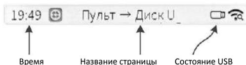
В средней части дисплея могут отображаться три типа страниц: Управление / мониторинг, навигация по меню и настройка функций.
